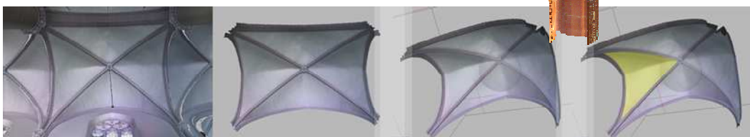
Ermittlung der Gewölbeflächen aus Laserscans
